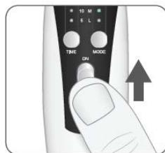
Si le préchauffage n'est pas nécessaire, appuyer simultanément sur les touches **MODE** et **TIME**, de cette façon l'appareil passera directement en mode veille.
